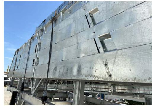
**Avec le cintrage trapézoïdal pour les couvercles de la trémie d'agrégats, une grande résistance peut être atteinte. Dans les trémies de stockage d'agrégats de SEMIX, des aciers de renfort supplémentaires sont soudés aux vides dans le trapèze. Grâce à cette méthode, les trémies de stockage d'agrégats peuvent servir de nombreuses années.**
