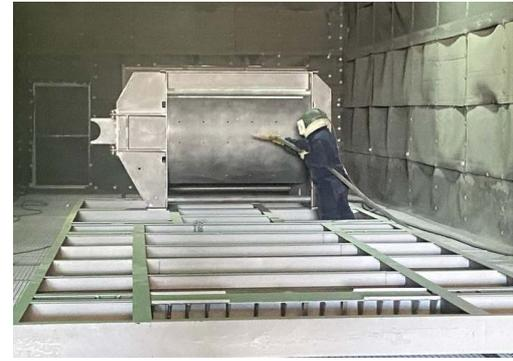
Tous les composants des centrales à béton SEMIX sont traités par processus de sablage au jet de grenaille dans l'installation de sablage certifiée de SEMIX avant la peinture avec des billes d'acier. Cette méthode fournit une qualité de finition de surface élevée après la peinture.
