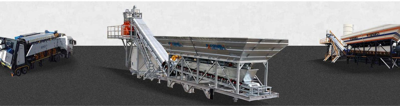
La SEMIX Mobile 60 S4 est équipée de malaxeurs à béton d'une capacité de 1500/1000 litres, qui peuvent être à arbre unique, à double arbre ou de type planétaire. Les malaxeurs à béton SEMIX sont équipés d'usure NiHard4 ou Hardox 450 en fonction du ratio de silicium de la recette du béton.
