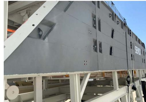
Le pliage trapézoïdal des couvercles de trémie à agrégats permet d'atteindre une résistance élevée. Dans les trémies de stockage d'agrégats de SEMIX, des aciers de renforcement supplémentaires sont soudés aux espaces vides du trapèze. Grâce à cette méthode, les trémies de stockage d'agrégats peuvent servir pendant de longues années.
