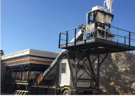
Vue d'ensemble : Le châssis principal a été construit conformément aux exigences internationales avec une hauteur de transition de 4 100 mm à 4 250 mm, avec des composants en acier de haute qualité et une excellente finition. Le châssis principal offre une grande facilité de manœuvre et de remplissage du camion malaxeur d'une largeur moyenne de 5 000 mm. Une plate-forme, des mains courantes et des escaliers sont intégrés au châssis principal.
